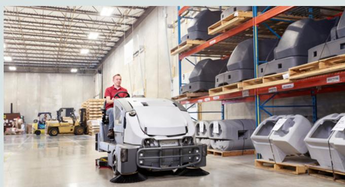
Технология SmartFlow™ корректирует расход раствора в зависимости от скорости машины, регулируя подачу воды и химреагентов. Большая продуктивность с меньшим числом циклов заполнения бака
