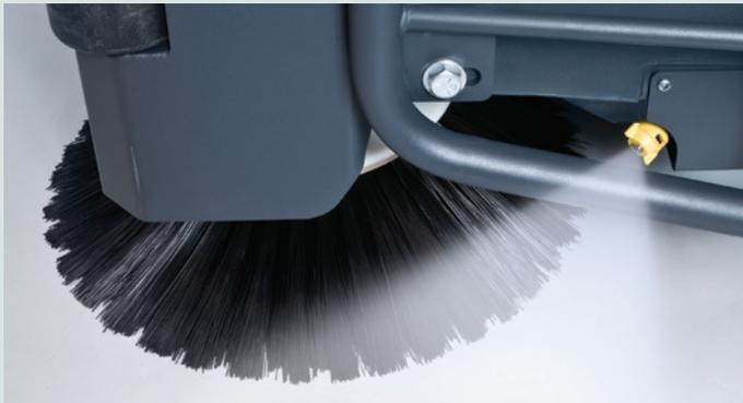
Доказано, что технология DustGuard™ снижает объем взвешенной пыли в процессе подметания боковыми щетками. Сверхтонкий туман улавливает сдуваемую пыль
